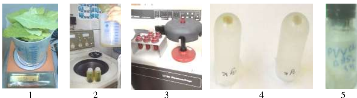
1 – листья N. tabacum , зараженные PVY Cherie ; 2 – низкоскоростное центрифугирование; 3 – ультрацентрифугирование с Basket-ротором SW28; 4 – осадок вирусного экстракта; 5 – высокоочищенный препарат PVY Ch .
